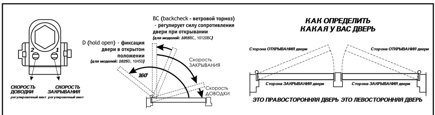
**ВНИМАНИЕ: ЗАПРЕЩАЕТСЯ ВРАЩАТЬ РЕГУЛИРОВОЧНЫЕ ВИНТЫ ПРОТИВ ЧАСОВОЙ СТРЕЛКИ БОЛЕЕ ЧЕМ НА ДВА ПОЛНЫХ ОБОРОТА ОТ ЗАВОДСКОЙ УСТАНОВКИ, ТАК КАК ЭТО МОЖЕТ ПРИВЕСТИ К ВЫПАДАНИЮ ВИНТА ИЗ КОРПУСА, ПРОТЕЧКЕ ЖИДНОСТИ И ПОЛОМКЕ ИЗДЕЛИЯ. НЕ ПЫТАЙТЕСЬ САМОСТОЯТЕЛЬНО ОТКРЫТЬ КОРПУС ДОВОДЧИКА - ЭТО ОПАСНО ДЛЯ ЖИЗНИ И МОЖЕТ ПРИЧИНИТЬ ВРЕД ВАШЕМУ ЗДОРОВЬЮ. ДОВОДЧИК ПОДЛЕЖИТ УТИЛИЗАЦИИ В ЗАВОДСКИХ УСЛОВИЯХ СПЕЦИАЛЬНО ОБУЧЕННЫМИ ЛЮДЬМИ.**
